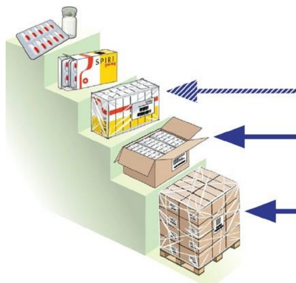
Abbildung 1: Verpackungskaskade (nach ISO/DTS 16791-2012)
